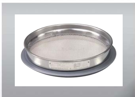
Sita do modelu Alpine 200LS: średnica/wysokość – 200/25 mm
